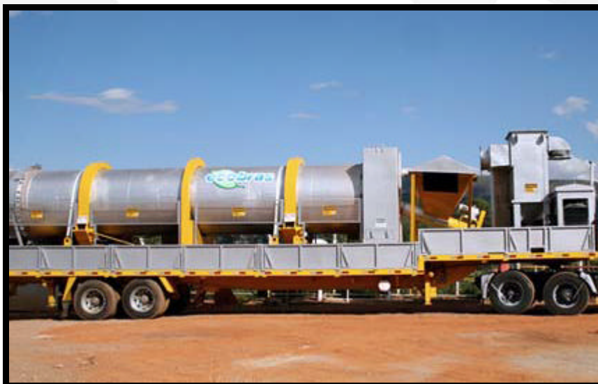
Foto 2: Plataforma de incineradores com fornos rotativos construída e operada pela Ecobrás no Estado do Rio Grande do Norte.
